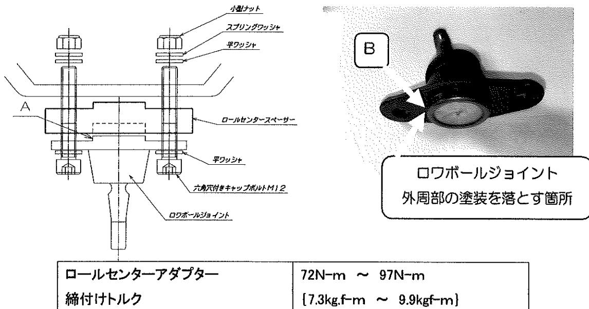
7)ロールセンターAJAスターロワアームをステアリングナックル側ボールジョイントの取付け、ロックナットで締め付けて割ピンを取付ける。
