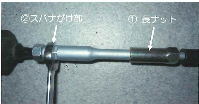
**注意** 必ずタイロッドとタイロッドエンドのネジのかみ込み量を確認して下さい。
