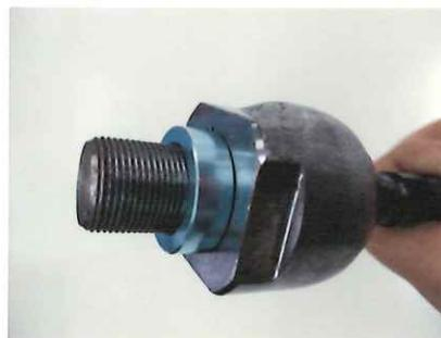
3) インナーソケットのステアリングラック取り付け部にネジロック剤（スリーボンド製、嫌気性強力封着剤No.1305相当）を塗布し、ステアリングラックに締め付けて下さい。
