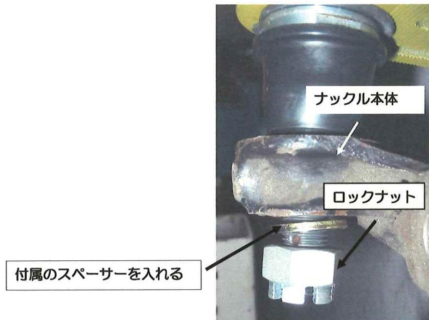
4)イケヤフォーミュラ「リア・キャンバーアジャスター・アッパー・アーム」をリアナックルに取り付け、ロックナットにて規定トルクで締め付ける。
