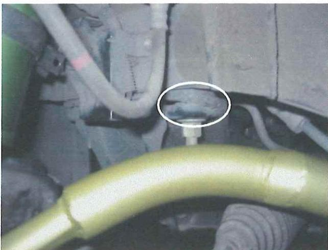
※ナット類は定期的な締め付けロック確認を必ず行う様心掛けて下さい。
