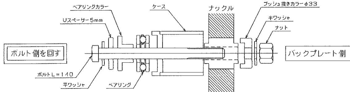
(2) 15mm程度抜いたら、付属品のUスペーザー10mmを追加してブッシュを抜き取って下さい
