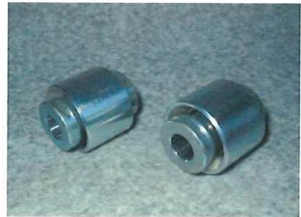
※カラーの向きに注意し、テーパー側が「ピロブッシュ」内側 になるようにセットし、締め付けを行つて下さい。
