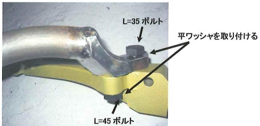
①弊社ロアアームと装着する場合、L=35・L=45 のボルトにはロワーム付属品の平ワッシャを必ず取り付けて下さい。
