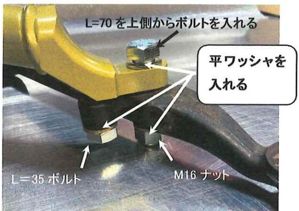
②付属品ボルト L=35 のボルトをテンションロッドの下側から仮締めして下さい。
