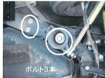
9)リアサスペンションメンバーを少し傾かせて、メンバースペーサーUP を溝側をゴムにして、ボディーとメンバーの間に取り付けて下さい。
