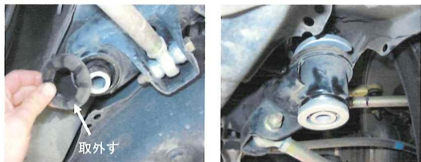
11)リアサスペンションメンバーストップバーを、ボルト3本で締め付けて下さい。
