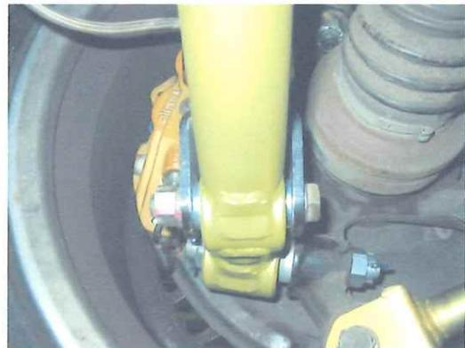
※ボルト・ナット類は定期的な締め付けロック確認を必ず行う様心掛けて下さい。
