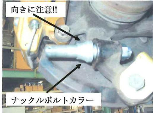
7)リアロワームをナックルボルトへ取り付け、規定トルクで締め付ける。
