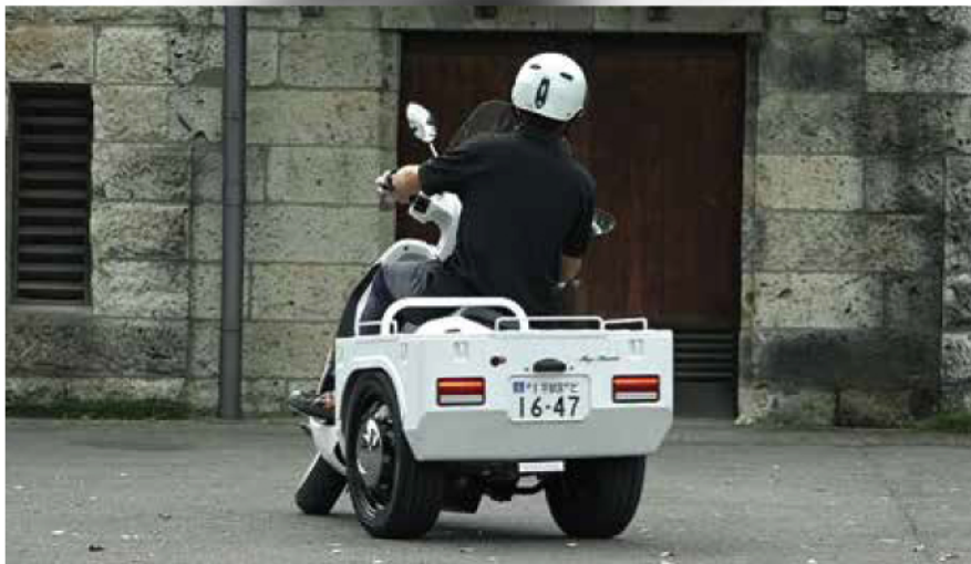
▲前輪とライダーは一体にバンク、荷台と後輪は水平を保って旋回します。
