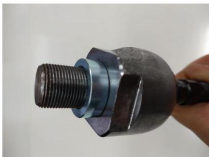
3) インナーソケットのステアリングラック取り付け部にネジロック剤（スリーボンド製、嫌気性強力封着剤No.1305 相当）を塗布し、ステアリングラックに締め付けて下さい。
