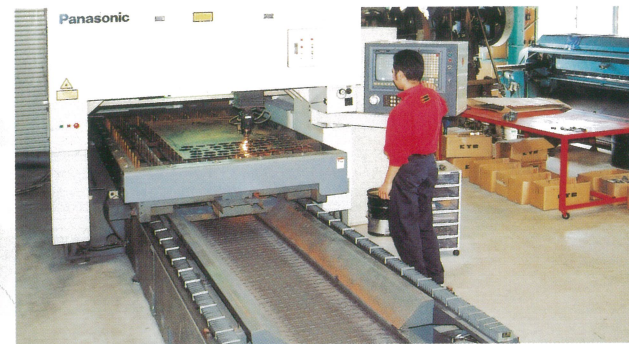
レーザー切断機(ステン12t、スチール20t、アルミ12tまで切断)
