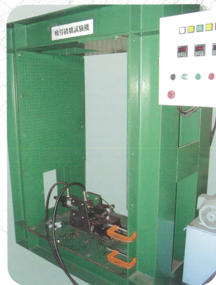
疲労破壊試験機(自社開発)による強度試験
